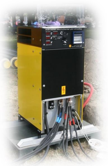
Obr. 6 Zařízení pro elektro-ohřev potrubí
